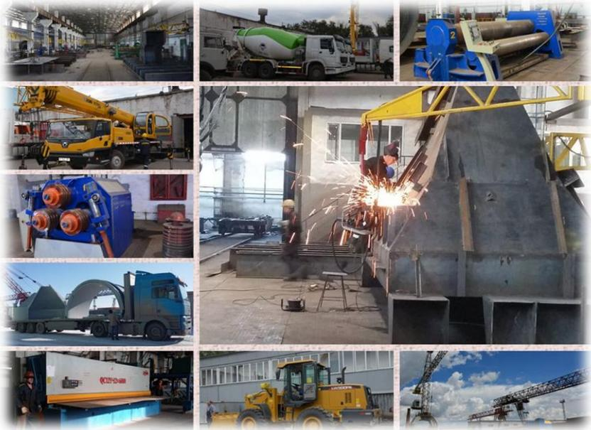
Монтажно-заготовительный завод предприятия, на котором выполняются работы по изготовлению металлоконструкций, оснащен по последнему слову техники. Здесь имеется и машина обработки металлопроката дробью (дробеструйный аппарат), и пескоструйный аппарат, гидравлические ножницы (гильотина), гидравлический 4-х роликовый гибочный станок (вальцы), гидравлический
